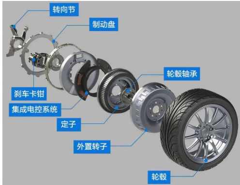
图 1 轮毂电机结构示意图
