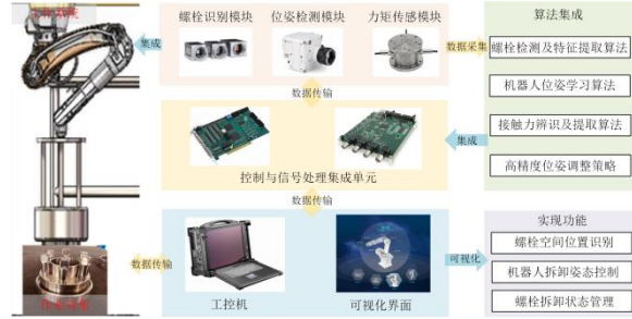
图 1 机器人螺栓拆卸系统整体方案
